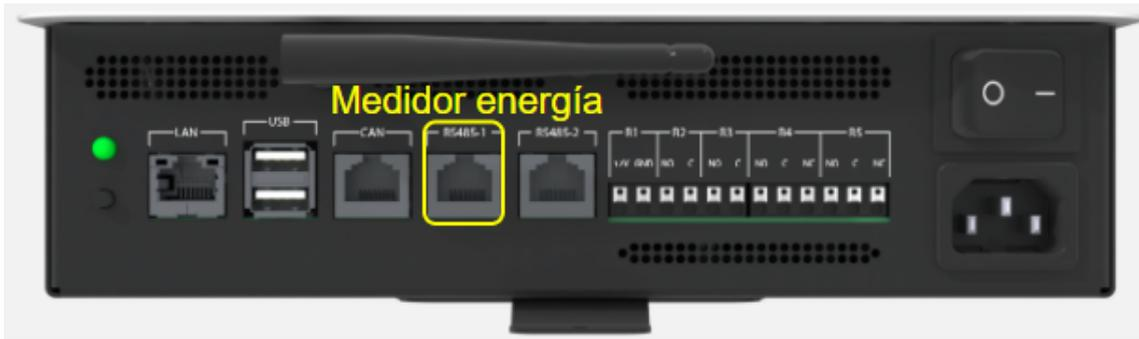
Figura 10. Conector de conexión del medidor de energía
