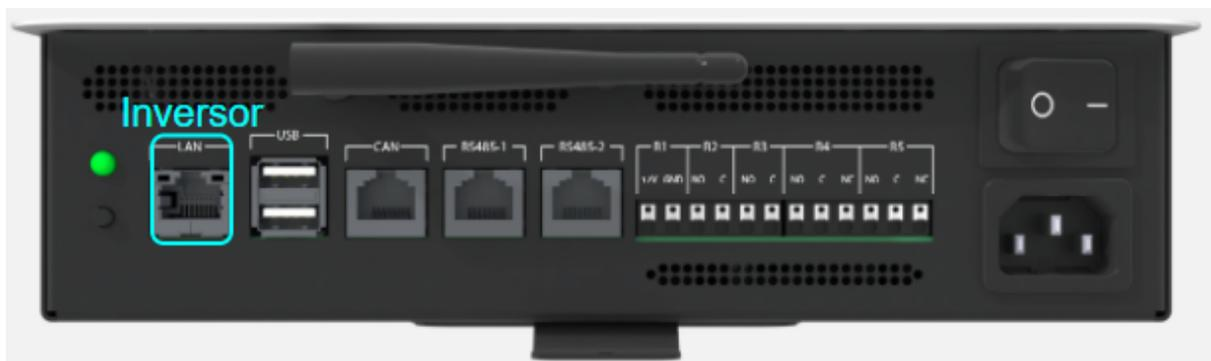
Figura 9. Conector de conexión del inversor
